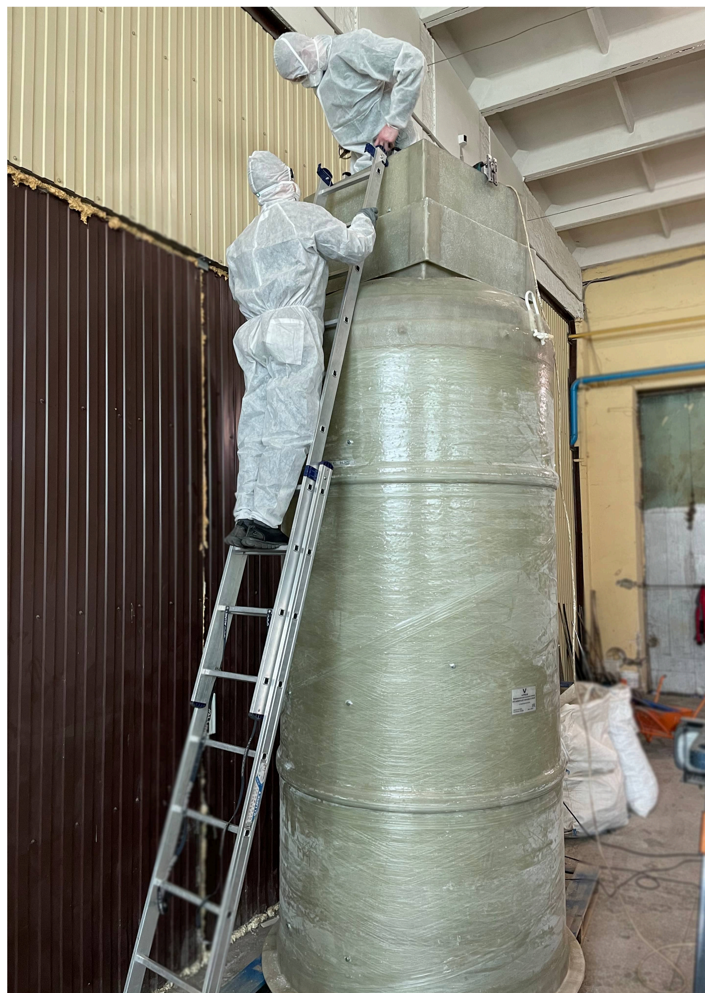
Канализационная насосная станция в стеклопластиковом корпусе с установкой под проезжую часть
